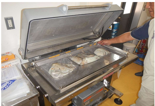
製造工程(真空包装)
