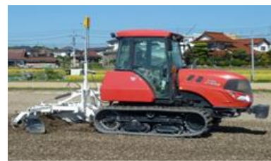
レーザーレベラーを装着したトラクターによる緩傾斜施工
