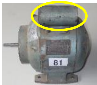
単相モーターに取り付けられた低圧コンデンサー
