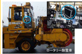
除雪作業車へ除雪作業の支援技術を実装（R4.10～）
