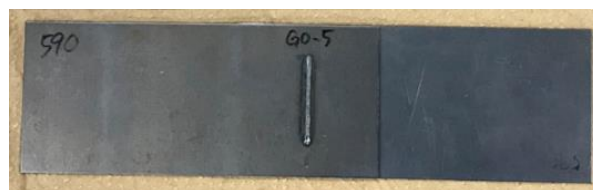
図1 引張りせん断試験片
