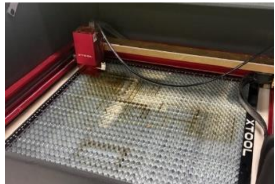
図 1 マーキング装置「xTool D1 pro 20W」
