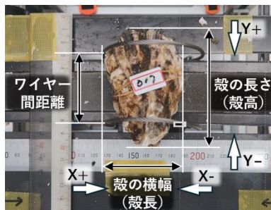
①10kgfの力付与による評価試験
