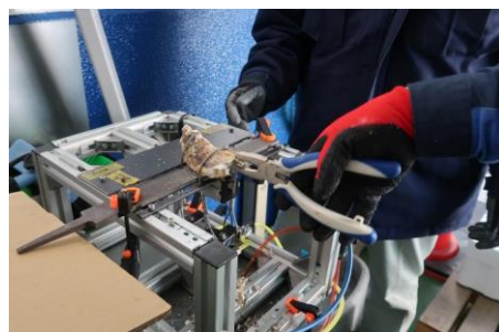
②ペンチで殻を破壊する評価試験（模擬 牡蠣打ち）
