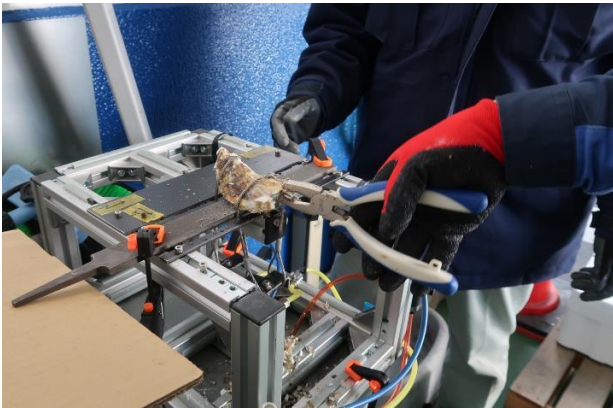
図8 ワイヤー間距離を 50mm にした試作機での検証
