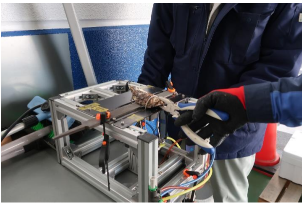
図7 殻割工程動作による固定可否の検証
