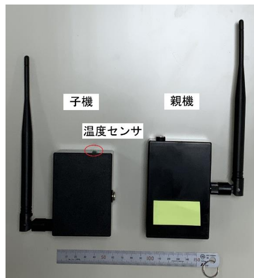
図2 温度計測の実装（入力ブロック）
