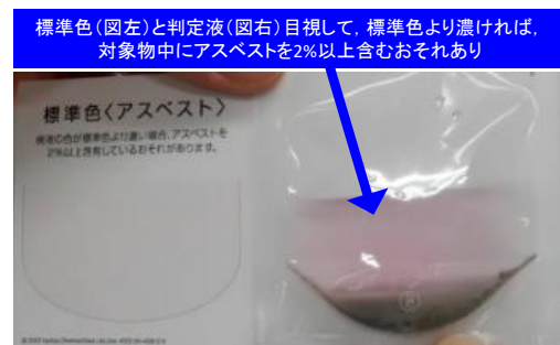
図2 アスベスト検出キットの判定方法
