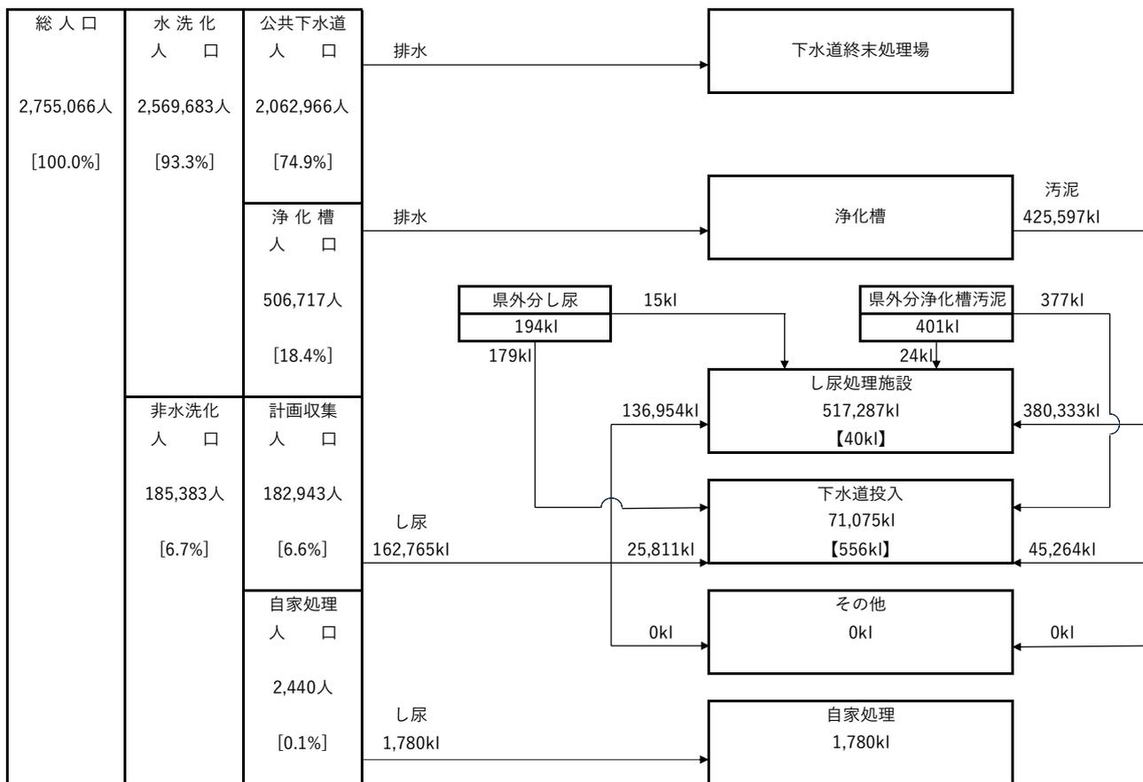
図3-1 し尿処理及び浄化槽汚泥処理の概要（令和5年度）
