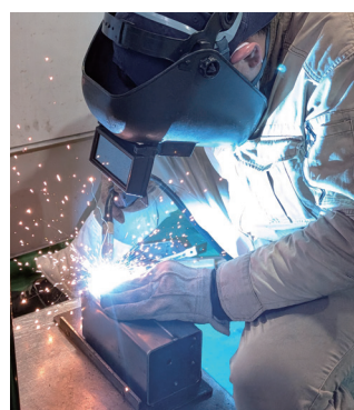
半自動アーク溶接
