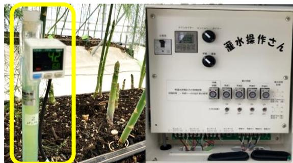
図2 土壌水分をモニタリングする pF センサー(左)と自動灌水装置の制御盤(右)
