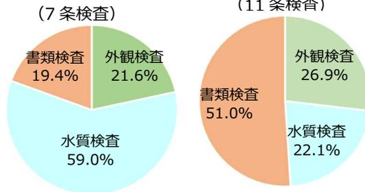
11条検査の不適正判定の浄化槽では、「水質検査」（放流水の状態悪化等）よりも、「書類検査」（記録票の未整備、必要回数不足等）や「外観検査」（漏水、水の流れや装置の不良等）で、より多くの不可項目が見つかっています。
