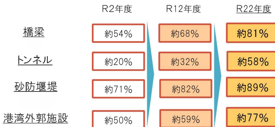
図 1. 11 建設後 50 年以上経過する施設の割合
