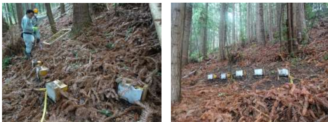
写真-3 土砂受け箱設置状況
