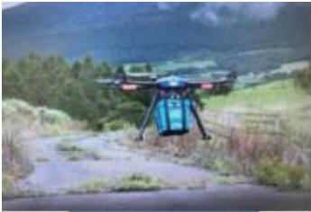
血液搬送装置を装着した無人航空機による輸血用赤血球製剤の輸送実験
