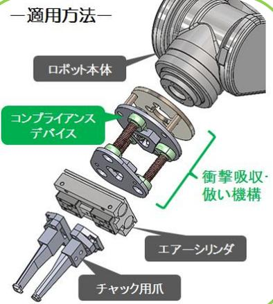
◆ 本機をロボットの手先に取り付けて、接触相手に做って変形しつつ、衝撃を大幅緩和させます。
