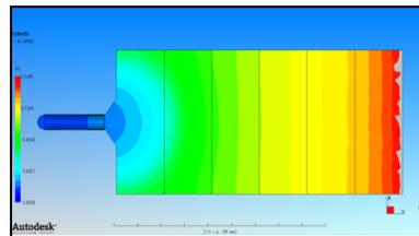
本装置による粘度データを用いた解析結果
