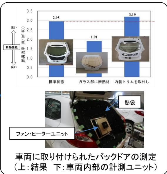
車両に取り付けられたバックドアの測定
