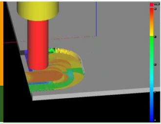
～ NCデータからのびびり振動予測とNCデータ修正による回避 ～
