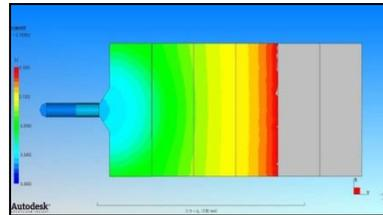
従来法による粘度データを用いた解析結果
