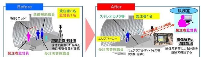
デジタルカメラ等で鉄筋間隔・鉄筋径等を撮影・解析し、出来形管理を行う。
