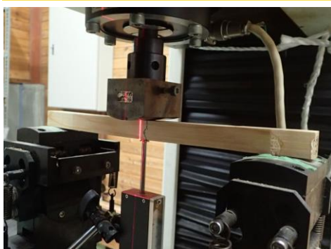
コウヨウザン材の強度試験
