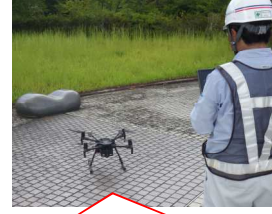
マルチスペクトルカメラ搭載のドローンで現地データ収集
