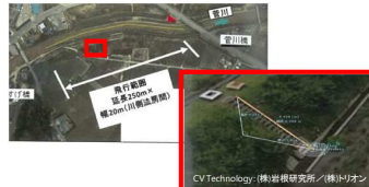
360°カメラによる動画から寸法を計測
