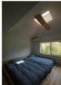
星や、月を眺めながら就寝ができる。既設の丸太を生かし、開閉式のトップライトは煙突効果で部屋中の空気を動かす。
