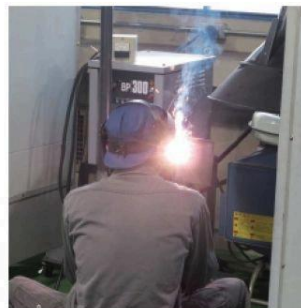
被覆アーク溶接作業
