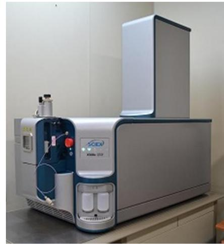
図3 液体クロマトグラフ-四重極飛行時間型
