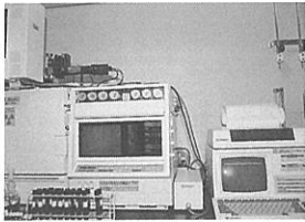
最新型ガスクロマトグラフ装置による迅速な残留分析
