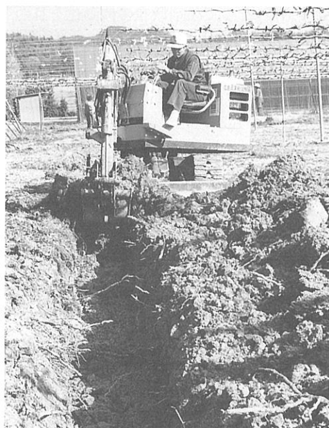
バックホー利用による粘質土壌改良
