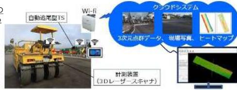
3Dレーザースキャナを重機に搭載し、路床や路盤の出来形点群データを取得。現場でリアルタイムにデータを処理後、設計データと比較して面管理を行う。
