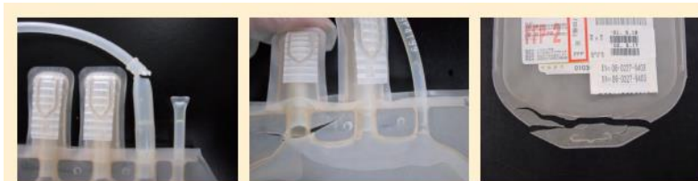
FFPバッグの破損事例
