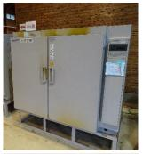
温度範囲 40~300℃ 含水率測定などのため 用涂 高温で試験材を乾燥 します。
