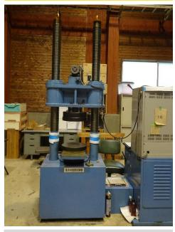
圧縮:2000kN(約200t) 最大荷重 試験用途 柱材、梁桁材、ラミナの 圧縮試験、
