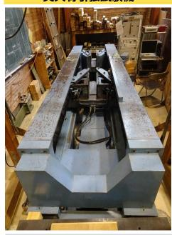
引張:500kN(約50t) 最大荷重 柱材、ラミナの引張試験、 試験用途 接合金具等の引抜強度 など
