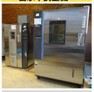
温度範囲 45~180℃ 20~98%RH 湿度範囲 用途 JIS試験に供する小試験体の 含水率を定温で調整します。
