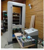
最大荷重 引張: 100kN(約10t) 試験用途 JIS小試験体の曲げなど
