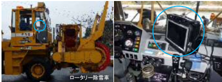
除雪作業車へ除雪ガイダンスシステムを設置し、実装実験を実施（R4.10～R5.3）
