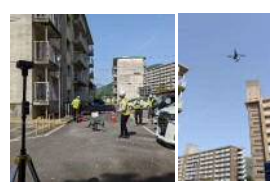
ドローンを活用した外壁の劣化状況調査の試行(R4.4)
