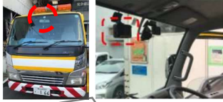
ドライブレコーダーで取得した画像をAI画像解析することで路面性状を把握する技術の構築（R4.10～）
