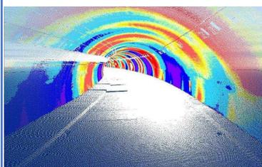
撮影展開画像からAIにてひび割れ等の変状を自動抽出し、さらに人手により確認・調整し、正確な寸法精度の変状展開図を作成できる。3次元レーザーデータからは内空変位をコンター図で表現し、外力に起因するひび割れの確認や、2時期の変位差分解析も可能。
