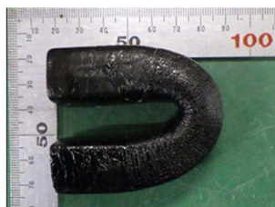
バインダ「エラスファルト」の弾力性
