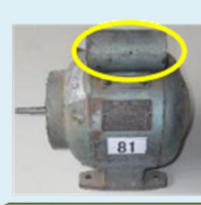
単相モーターに取り付けられた低圧コンデンサー
