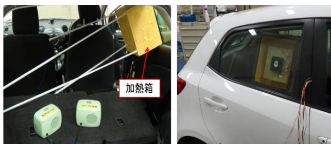
図5 加熱箱取付例 (測定部品：サイドドア ガラス部)
