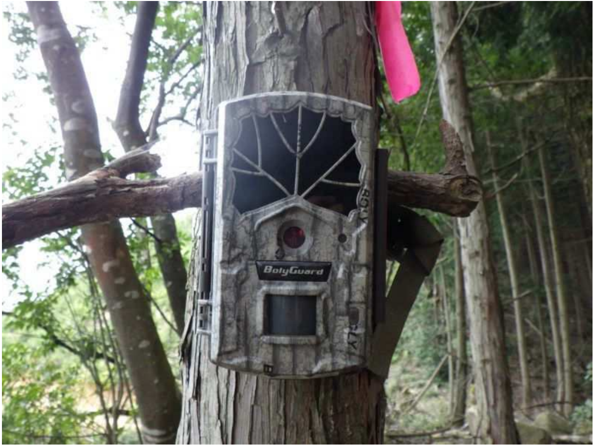
通信機能を有さないセンサーカメラ
