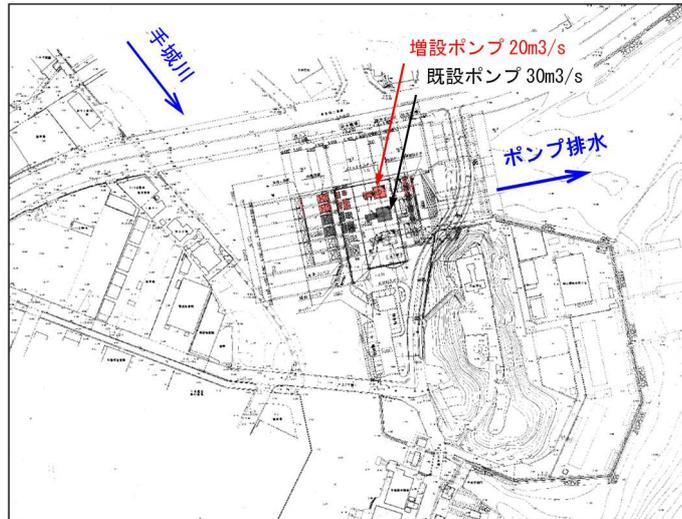
図2 手城川排水機場平面図・機器設置状況
