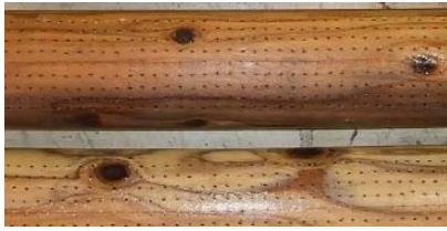
写真1 径2mmの穴をあけた材
