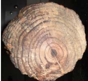
写真2 樹脂を浸み込ませ補強したスギ腐朽材
