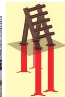
土砂等捕捉工
