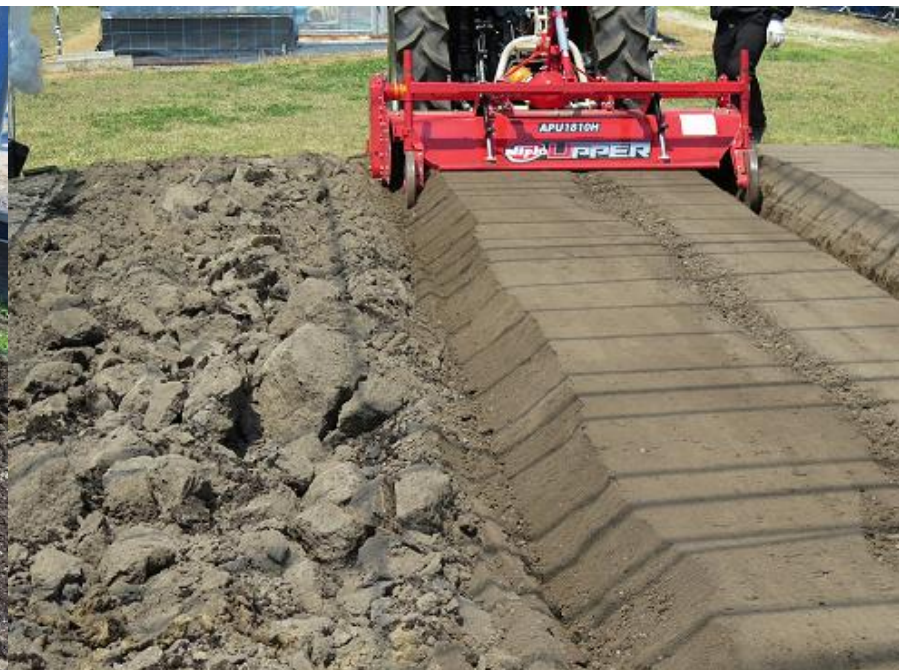
プラソイラにより発生した下層土を含む土塊を逆回転ロータリーで碎土
