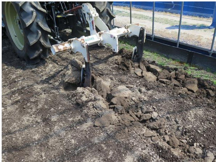
プラソイラ（スガノ農機）による耕盤破碎と下層土の一部反転
