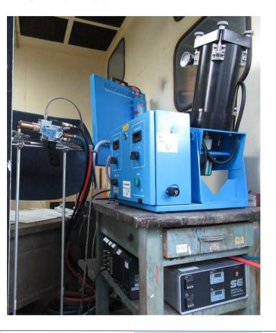
○フレーム溶射装置
