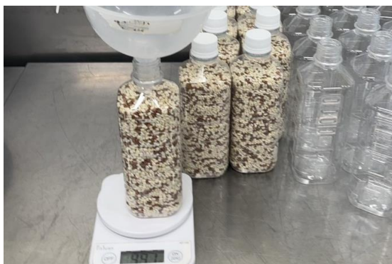
呉工場 ブレンド・計量・充填・閉蓋
