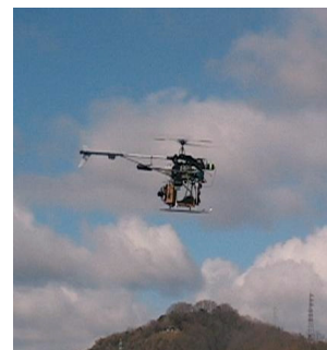
図6 小型ロータリーエンジンを搭載した無人小型ヘリコプターのテスト飛行
