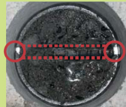
鉄筋感知装置を使わない場合
