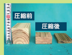
6cmの木材を3cmに圧縮。6cm以内であれば、任意の厚さに加工できます
