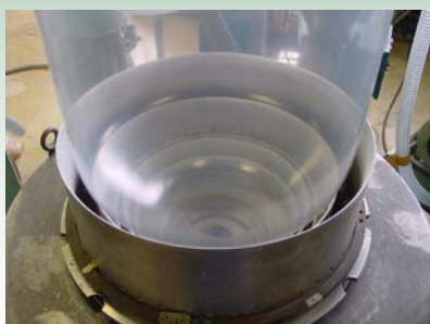
上記製品の製造工程 溶融した樹脂に空気を吹き込み薄いフィルムに加工していく
