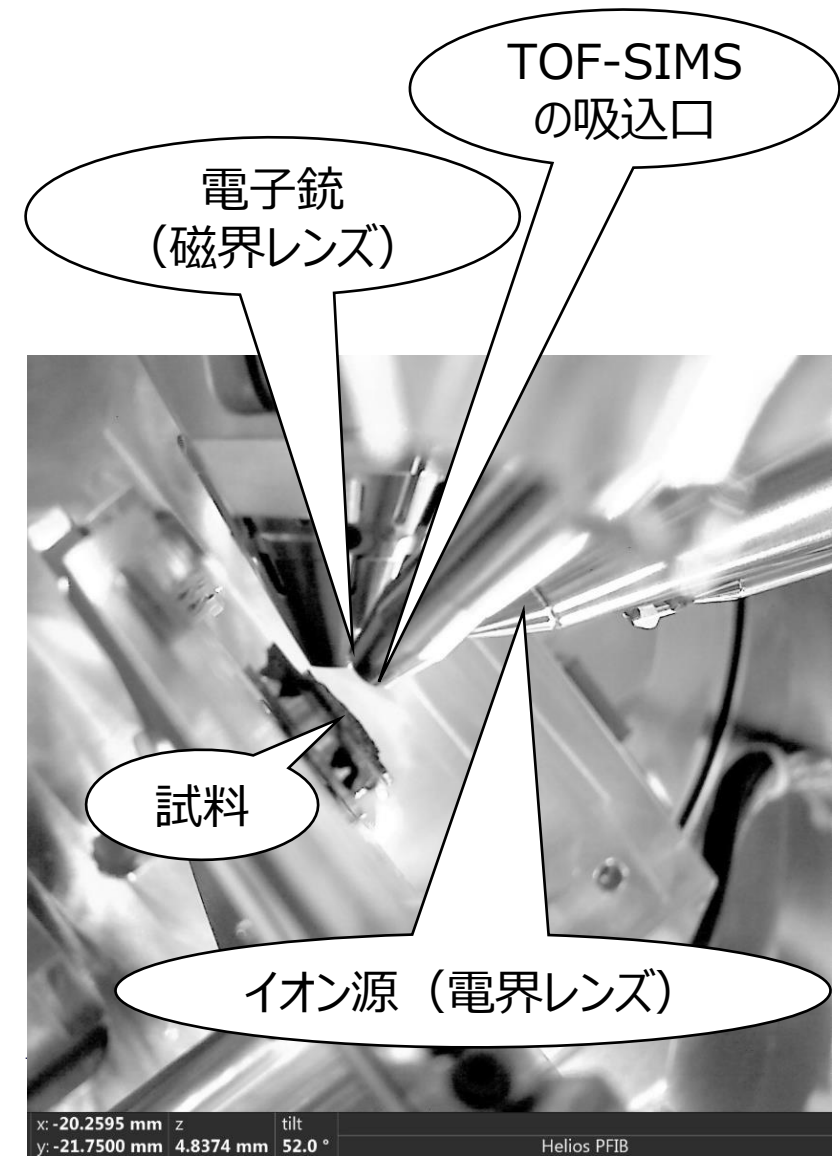
FIB-TOF-SIMSの試料室内部
