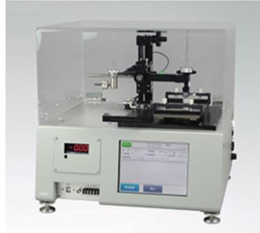
**平面往復式摩擦摩耗試験機**
