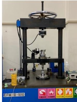
**回転式摩擦摩耗試験機**
