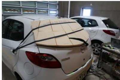
ガラス部からの熱漏れがないように断熱材で塞いだ状況
