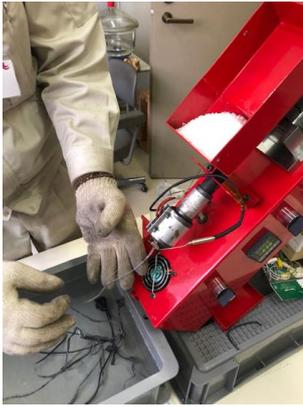
図1 小型押出機による混練の様子
